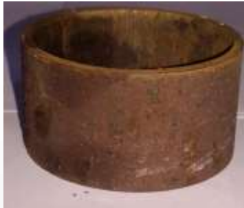
صورة فوتوغرافية لعينات المواسير بعد التنظيف
