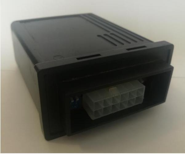
عند تحويل السيارة للعمل على الغاز يقوم الجهاز بتقديم فترة تداخل Overlap Period بين دخول الغاز وقطع إشارة الرشاشات Injector Signal Cut off لضمان تشغيل السيارة بطريقة جيدة خلال الفترة الانتقالية. هذه الفترة يمكن التحكم فيها بالزيادة والنقصان من خلال مفتاح ضبط Trigger.
